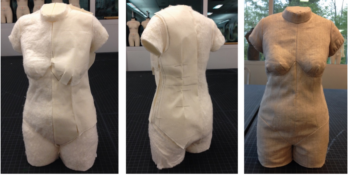
Görsel 11.7. 3B tarayıcıyla kişiye özel hazırlanmış ½ ölçekli manken (Ashdown, Devine, Barker, Ruoff ve Cegindir, 2014).
